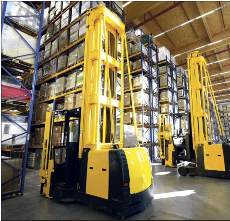
Stapler mit bester Aussicht: Diese Stapler werden im Hochregallager eingesetzt. Die Kabine kann auf zehn Meter hochgefahren werden. Dadurch legen die Staplerfahrer täglich rund 1.000 Höhenmeter zurück.
